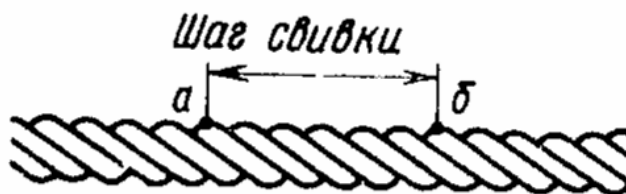
Рис. 2 - Схема определения шага свивки шестипрядного каната
