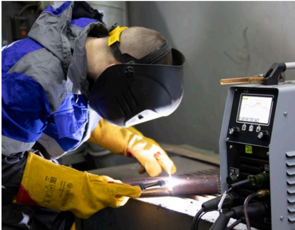
По словам инженера лаборатории сварки УАВР Павла Кинцеля, такой аппарат должен применяться на объектах КС и ГРС, где используются трубы малого диаметра – меньше 25 мм – и с толщиной стенки менее 3 мм. Согласно стандарту ПАО «Газпром», «варить» такие трубы следует ручной аргодуговой сваркой.
